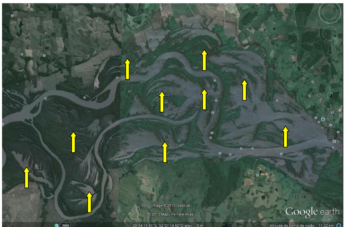
Figuras 03 (acima) e 04 – Imagem do Google Earth (G.Camara/Butiá montante barragem).. As setas amarelas apontam para locais onde a imagem ressalta inúmeras linhas de erosão/acrecção recentes..
